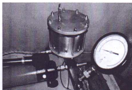
Slika 12. Hidraulična pumpa za nanošenje bočnog pritiska
